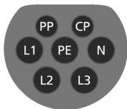
Illustration 2: Affectation des broches du connecteur type 2 pour le raccordement à la station de recharge (EVSE)
